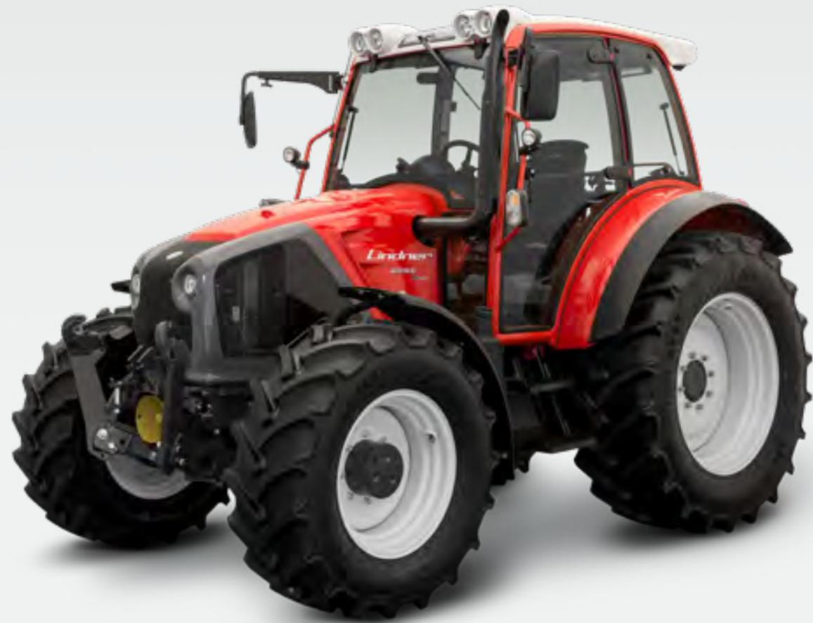
**La serie Geotrac 4 comprende attualmente otto modelli da 75 fino a 144 CV. I punti di forza tecnici dei trattori sono la cabina comfort panoramica, la sospensione della cabina, il sistema di compensazione delle oscillazioni, il sollevatore frontale o la potente idraulica d'esercizio con impianto dell'olio separato. Tutti i trattori sono allestiti con motori Perkins.**
